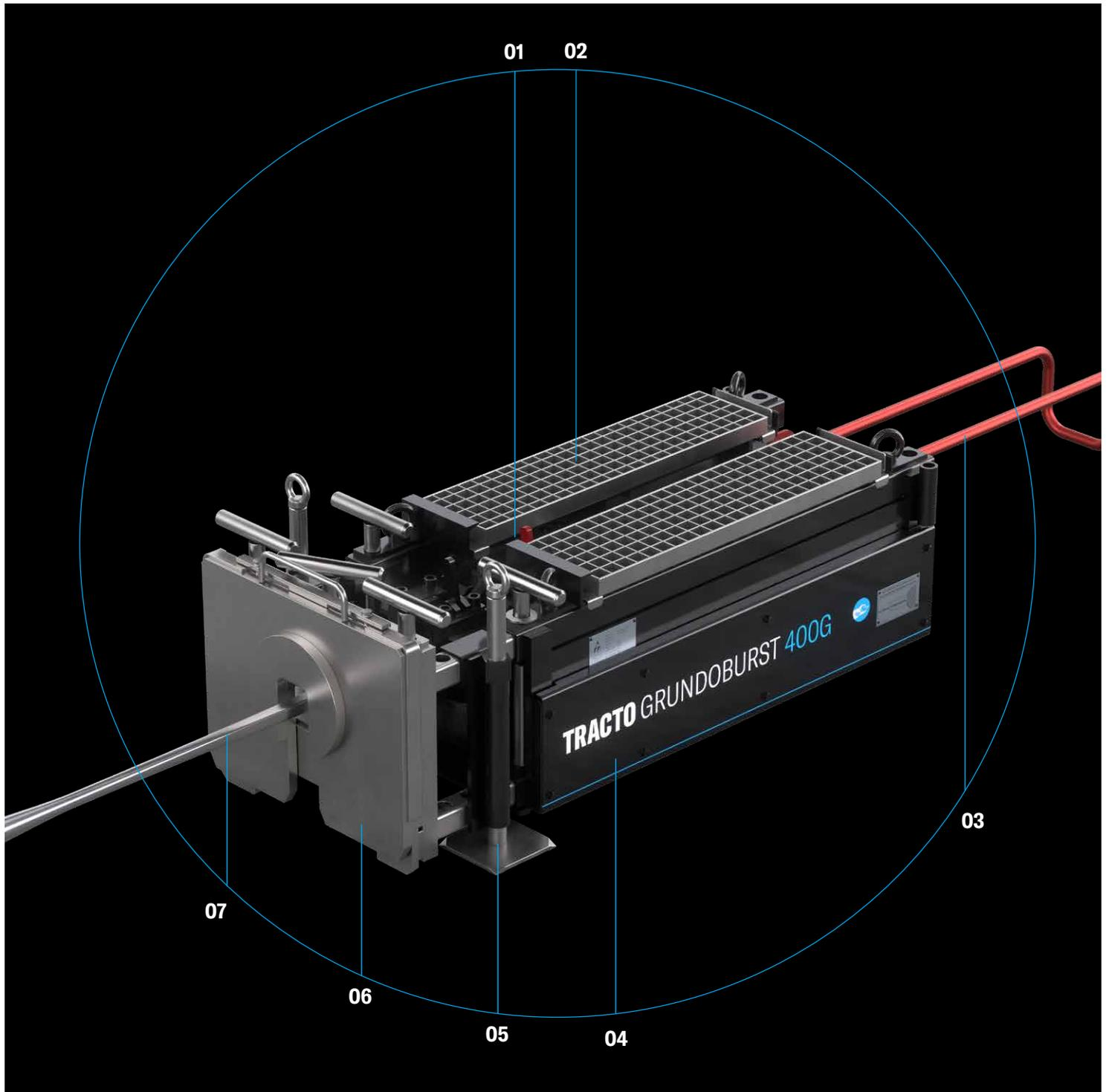
**01 Zwei Rastfinger** – geringer Verschleiß, volle Kraftübertragung, optimale Gestängesicherung, formschlüssige Verbindung, kein „Nachrutschen“ bei elastischen Böden
