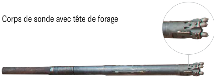
Unité de forage de roche avec tricône
