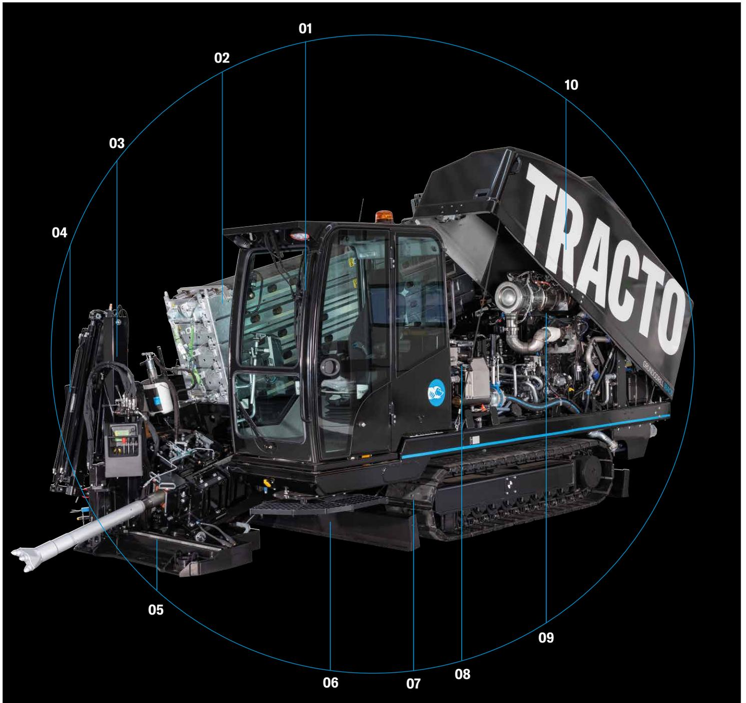
**01 Cabine de confort** à réglage hydraulique et amorti – conviviale, excellente visibilité, et à positionnement variable
