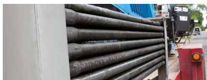
Gestängemagazin Kapazität 61 Meter, optional 76 Meter
