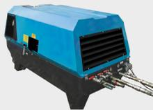
Bei den hohen Treibstoffpreisen ist der 20 % geringere Verbrauch erwähnenswert. Der Dieseltank hat eine Kapazität von 22 l, der Hydrauliktank von 66 l.
