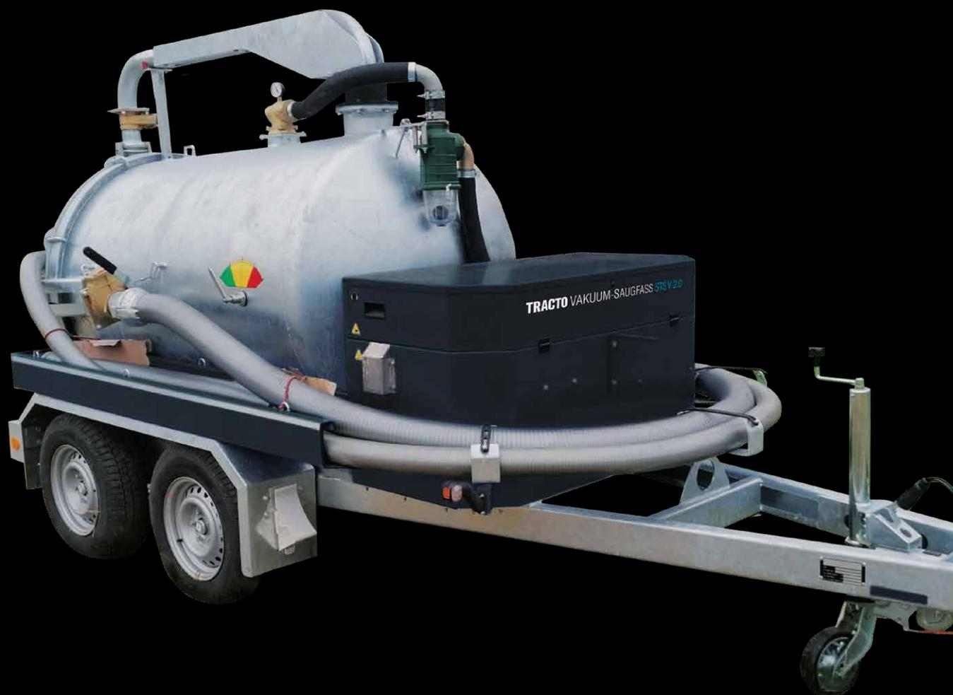
Un fût d'aspiration est une excellente solution pour évacuer du fluide de forage, de la boue ou d'autres liquides de la fouille.
