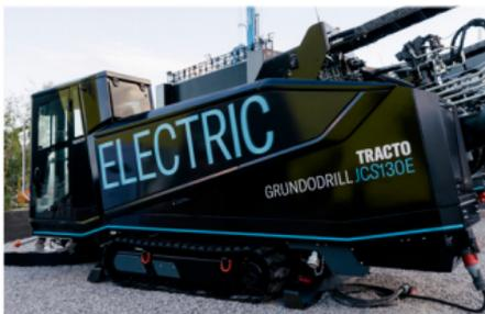
Elektrisch angetriebenes HDD-Bohrgerät für emissionsarme Baustellen
